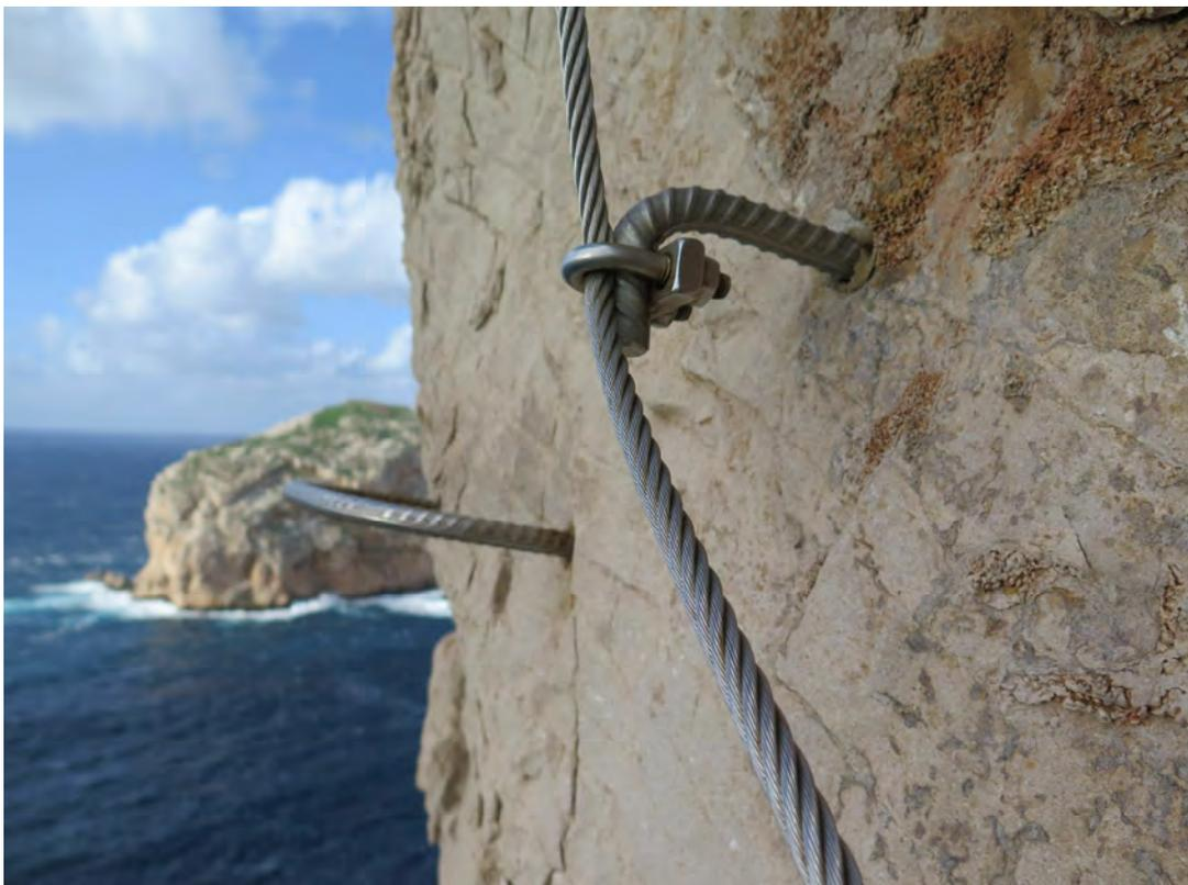
Ancoraggio artigianale resinato male con la barra di acciaio che si muove nel foro
